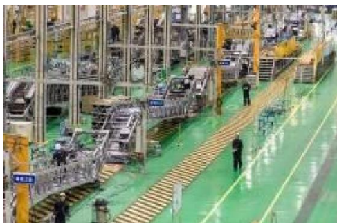
自动扶梯生产线
